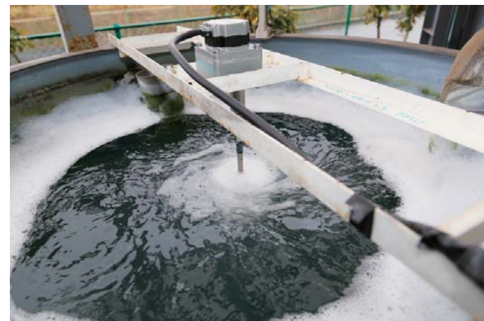
▲和土住宅公園での実証実験に使用する試作品 自社工場排水の曝気装置として試験利用
