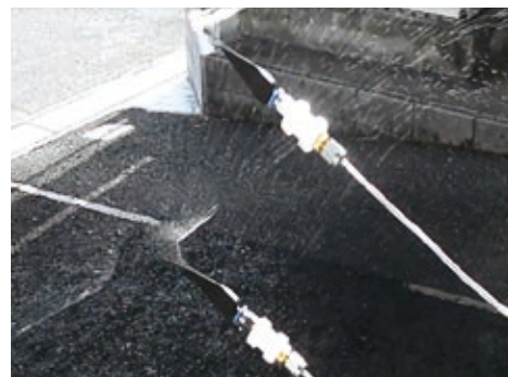
▲レインカーテン 自然に近い雨を低水圧で再現
